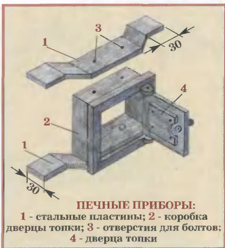
Эта дверца прослужила уже 20 лет. Пластины крепко держат коробку в кладке печи
